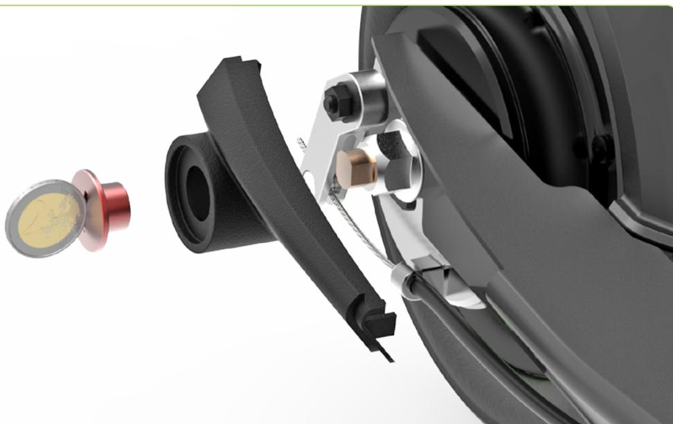
Schlauch Vorderrad ersetzen: Trommelbremsfelge kann leicht in zwei Hälften zerlegt werden. Siehe Bild unten.
