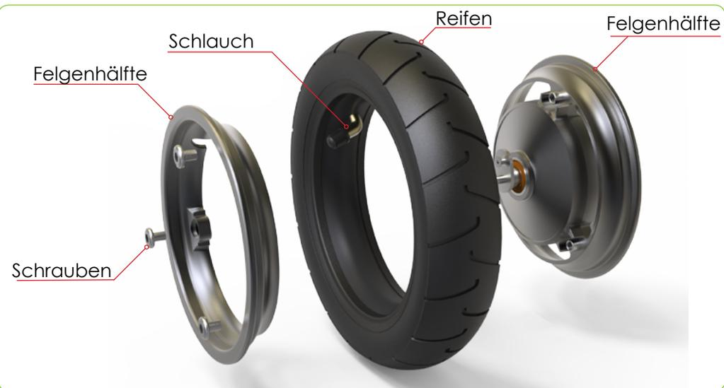
Ersetzen des Schlauches vom Heckmotor:
