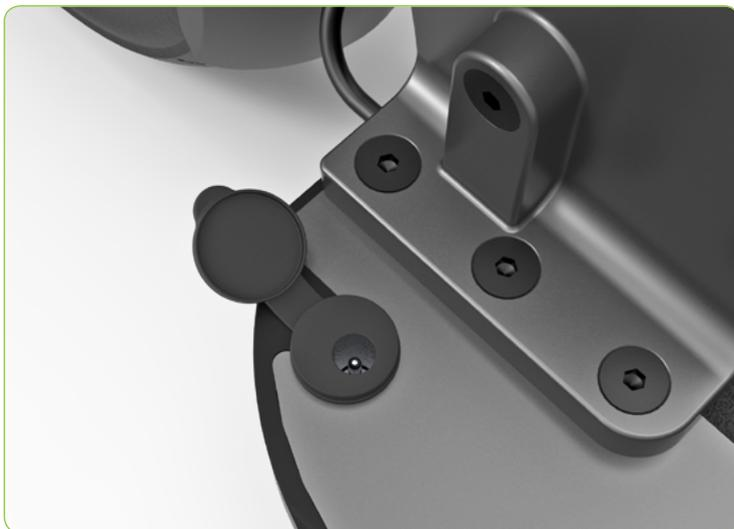
Ihr INOKIM Scooter hat ein externes Ladegerät. Schließen Sie das Ladekabel an die Ladebuchse des INOKIMs an der linken Oberseite des Decks an.
