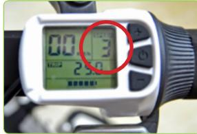
**Speed mode 3** - Maximale Geschwindigkeit von 20 km/h.
